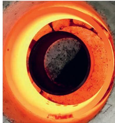
Abb. 4: CrMoV Ringspaltversuch mit keiner Induktion im inneren Ring
