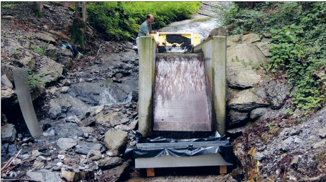
Abbildung 4: Feldversuch zum Abweisungsgrad von Feststoffen beim Coanda-Rechen am Mühlbach bei Oberschan (CH) mit einer Spaltweite von 1.0 mm. Der Abweisungsgrad der Feststoffe ist ungünstiger als von den Rechenherstellern in ihren Werbebroschüren suggeriert.
