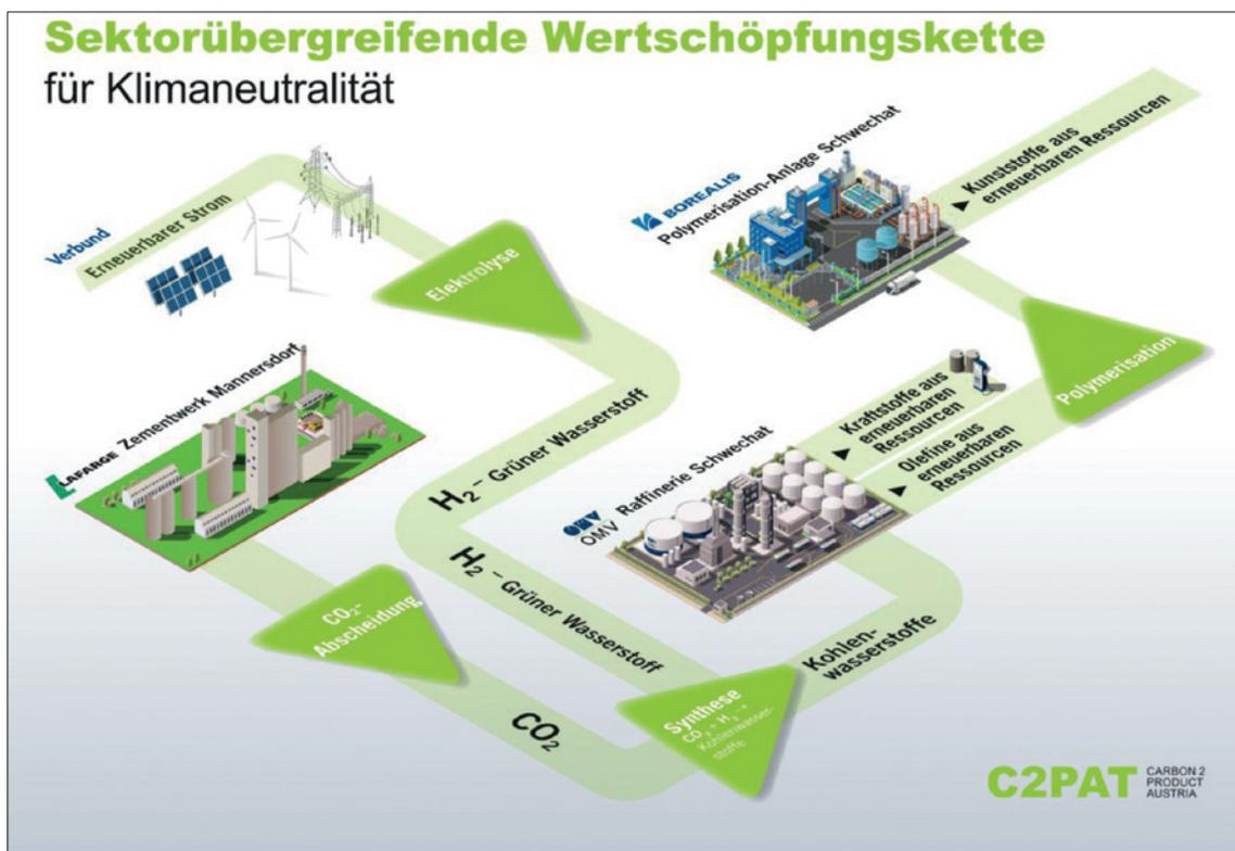
Abbildung 8: Schematisches Fließbild der zukünftigen, sektorübergreifenden Power-to-Liquid Anlage ([https://www.lafarge.at/fileadmin/Bibliothek/1\\_Ueber\\_Uns/Presseaussendungen/C2PAT\\_Infografik\\_Dekarbonisierung\\_062020\\_DE\\_cf.pdf](https://www.lafarge.at/fileadmin/Bibliothek/1_Ueber_Uns/Presseaussendungen/C2PAT_Infografik_Dekarbonisierung_062020_DE_cf.pdf))
